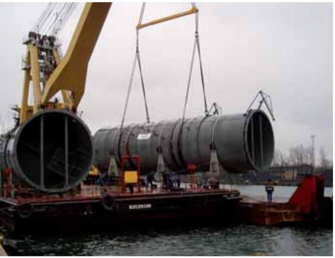
Trasporto combinato terra-mare-fiume-terra con utilizzo chiatte autoimmergenti: 2 absorbers (200 t. cad. - dia: 7m.) - Polonia-Polonia
