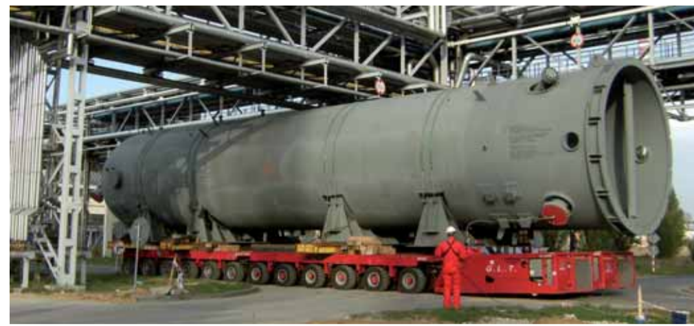
Trasporto combinato terra-mare-fiume-terra: reattore (414 t. - 26 m. - dia: 6 m.) - Italia-Polonia
